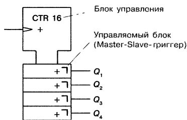
Рис. 10.8. Сборная схема 4-битового двоичного суммирующего счетчика на Master-Slave-триггерах, согласно DIN 40900, часть 12, CTR 16 означает 16 счетных разрядов (CTR — Counter, англ. счетчик).
