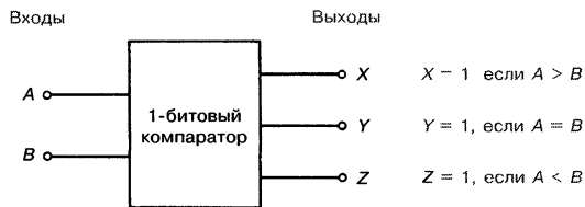
Рис. 11.15. 1-битовый компаратор и его таблица истинности.
